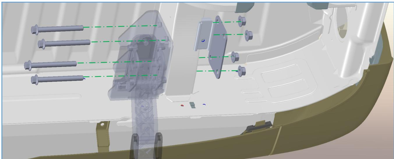
Nutzen Sie hierzu die beigefügten Schrauben M12x110. Auf der Fahrzeug Außenseite kommt noch eine Konterplatte hinzu und Je eine Selbstsichernde Mutter M12.
