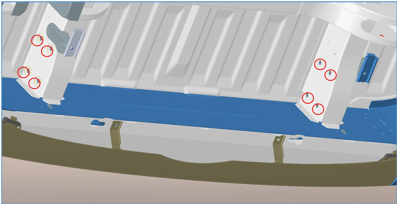
Sind alle befestigungspunkte lokalisiert, beginnen Sie mit Halter Montage am Fahrzeug.
