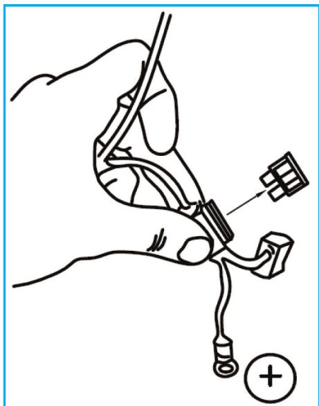
Entfernen Sie die Sicherung
