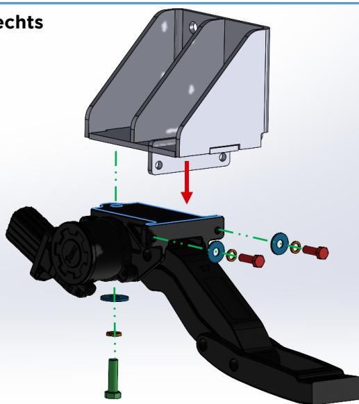
Auf der Halter Unterseite wird das Gelenk noch mit einer M10er **Schraube**, einem **Federring** und einer **U-Scheibe** befestigt.
