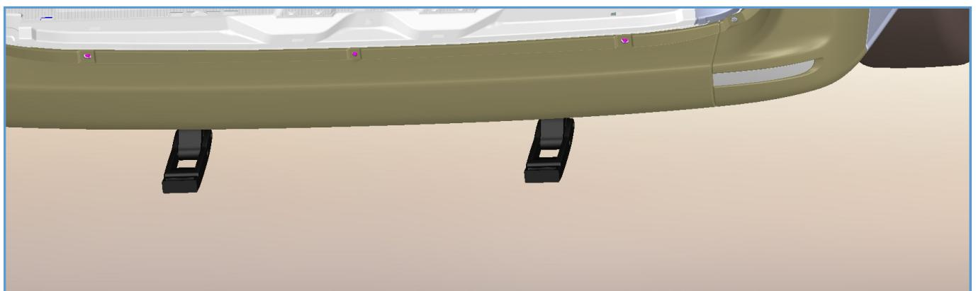
Im nächsten Schritt, wird das Trittbrett (960mm) montiert.
