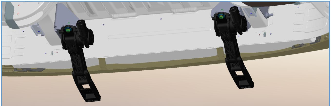
Ziehen Sie die Verschraubungen gut fest und Prüfen Sie diese auf selbständiges Lösen (Federring vorhanden, ggf. Schraubensicherung Loctite verwenden).
