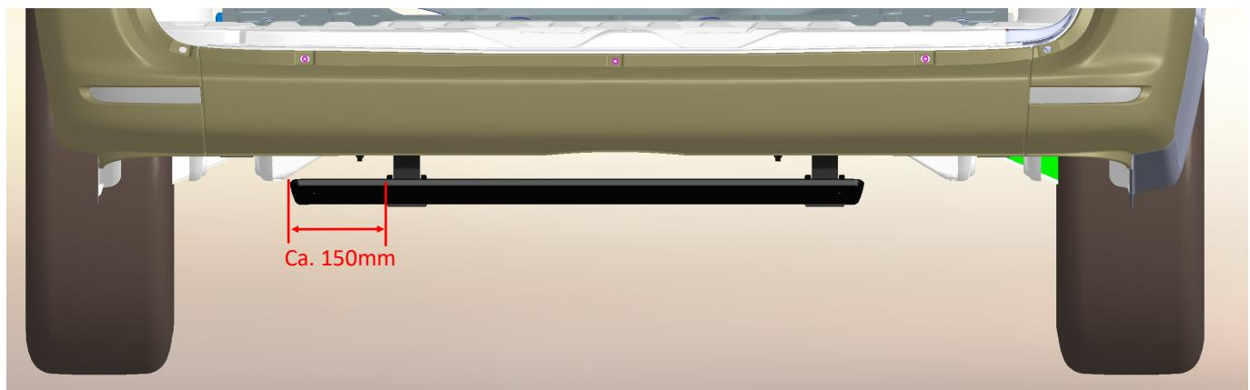
Verschrauben sie das Trittbrett mit den M8 ISK-Zylinderkopfschrauben. Das Trittbrett hat an der linken Anschlagseite einen Abstand von ca. 150mm. Je nach Ausführung sitzt der Auspuff auf der rechten Seite.
